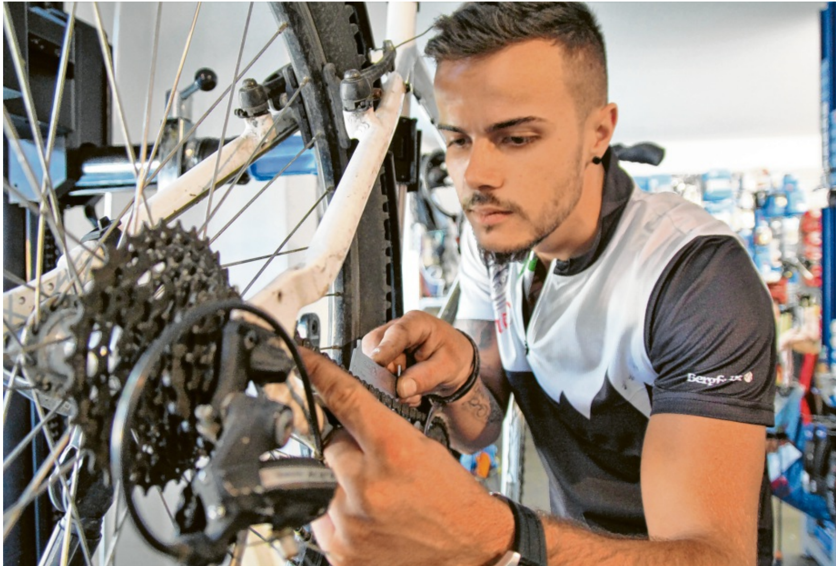
Pascal Hintermayr überprüft die Kette am Rad unseres Mitarbeiters mit einer Rohloff-Lehre. Das Fazit: Die Kette fällt durch.
